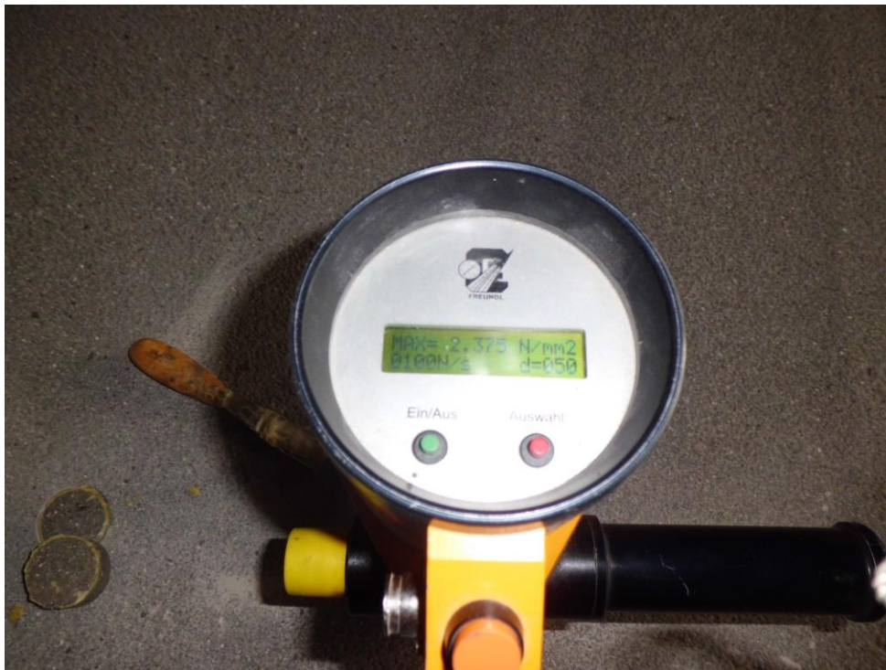
Messung der Abreissfestigkeit
